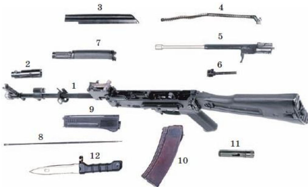
Рис. 35. Основные части и механизмы автомата АК-74: 1 — ствол со ствольной коробкой, прицельным приспособлением и прикладом; 2 — дульный тормоз-компенсатор; 3 — крышка ствольной коробки; 4 — возвратный механизм; 5 — затворная рама с газовым поршнем; 6 — затвор; 7 — газовая трубка со
